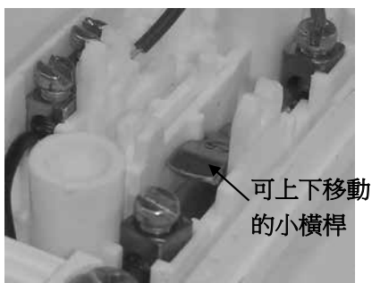
圖 7：「中途開關制」的內部結構
